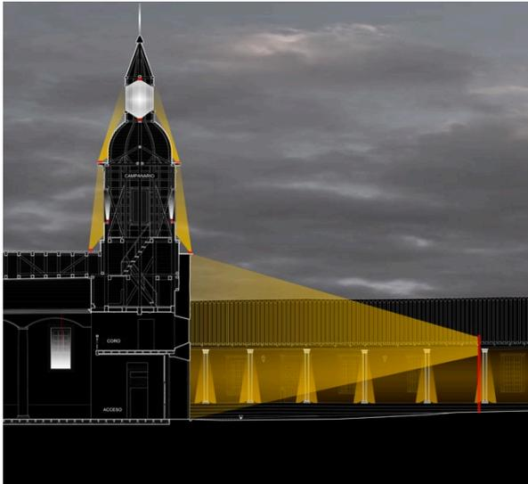
Detalle esquema de iluminación exterior de Fachada Principal y Torre.
